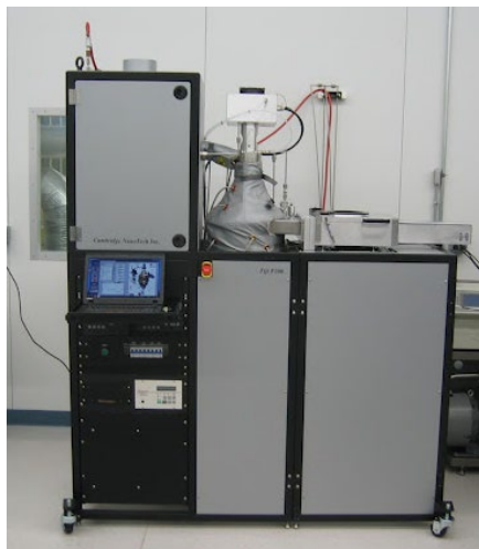
شکل ۱- تصویری از دستگاه رسوب‌دهی لایه اتمی برای سنتز فیلم‌های نازک.
