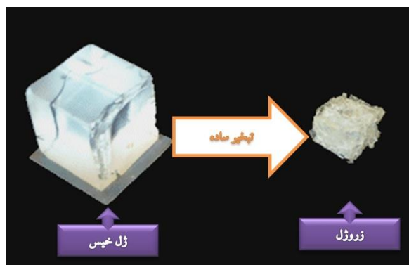
شکل (۶) خشک کردن به وسیله تبخیر ساده و تولید زروزل [۵]
